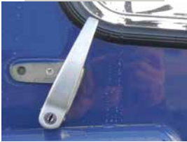
Griff nach oben drehen und Tür nach hinten schieben.
