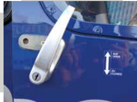
Griff nach oben drehen - Tür schwingt automatisch auf.
