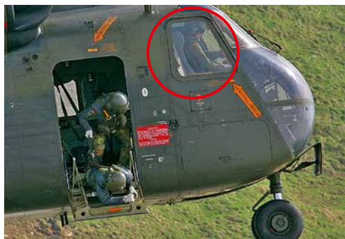
Die Cockpitseitenfenster (rechts und links) sind ebenfalls Notzugänge.
