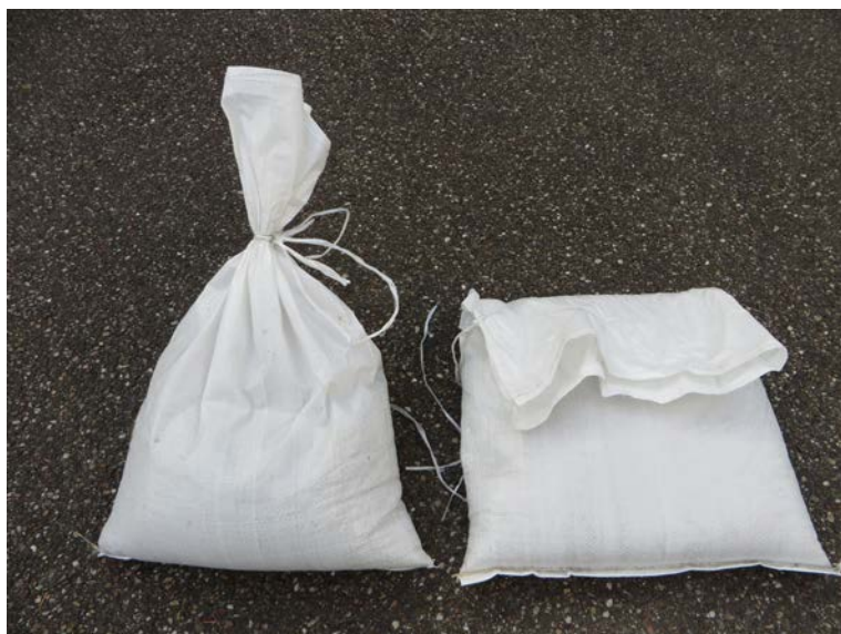
Abb. 6: Sandsack gebunden und umgeschlagen
