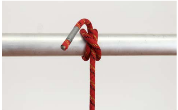
Phase 4: Mastwurf überschieben, festziehen
