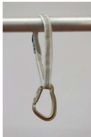
Doppelt Umschlagen: Bruchlast: 200%
