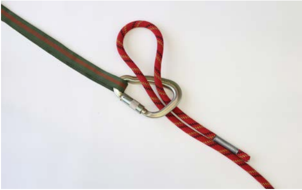
Phase 1: Ein Auge durch den Karabiner legen
