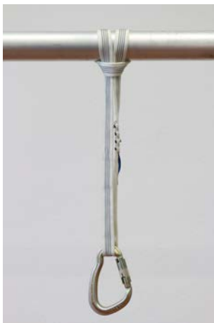
Schnürgang auslaufend Bruchlast: 75%
