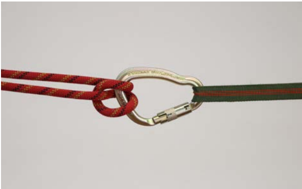
Phase 3: Seilende anziehen – das Auge klappt dadurch um
