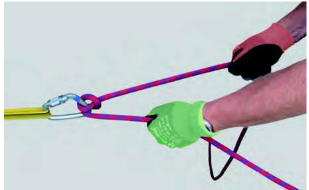
Phase 2: Seil einziehen, Knoten springt über
