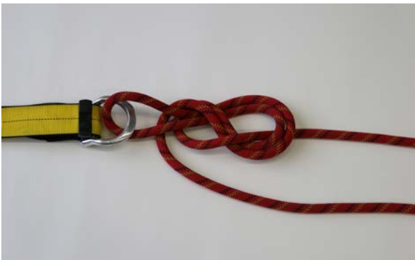
Phase 4: Eingebundene Acht mit seilende nachstechen
