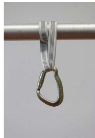
Doppelt Umschlagen: Bruchlast: 200%
