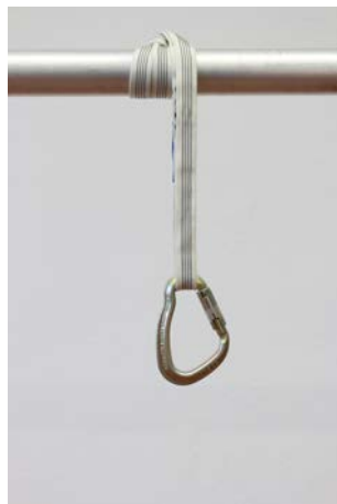
Schnürgang: überschlagen Bruchlast: 30%
