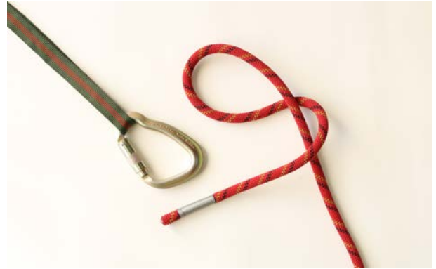
Phase 2: Seilende um das Seilführen
