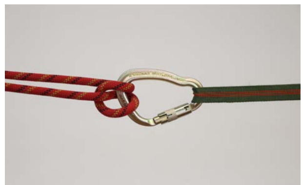
Phase 6: Karabiner schließen und Funktion prüfen
