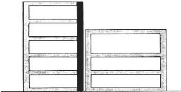
BILD 3: BRANDWAND ZWISCHEN GEBÄUDEN
