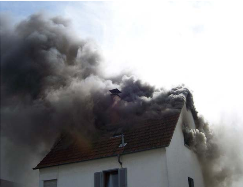
Abbildung 10: Sehr starke, dunkle und turbulente Rauchentwicklung – ein Hinweis auf eine mögliche Rauchgasdurchzündung? Die etwas dunklere und gerade aufsteigende Rauchsäule im linken Dachbereich spricht eher für einen aufgebrannten Dachstuhl und die grünlich-weiße Färbung des Rauches aus dem Giebelfenster für ein erstes Wirken der Brandbekämpfung.
