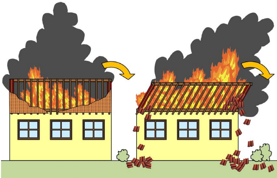
Abbildung 14: Eine zur Seite hin einstürzende Giebelwand kann über die Firstpfette auch die Sparren und die zweite Giebelwand mitreisen.
