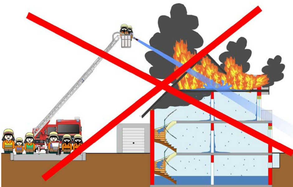
Abbildung 19: Bei einem Dachstuhlbrand in einem Wohnhäuf wird ein Wenderohr nicht eingesetzt
