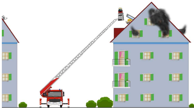
Abbildung 7: Menschenrettung aus einem Dachflächenfenster ohne Nutzung des Gelenkes.
