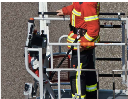
Abbildung 19: Sicherung mit Feuerwehrhaltegurt
