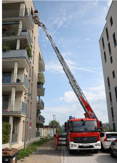
Abbildung 36: Erreichen von Anleiterstellen durch genaue Positionierung
