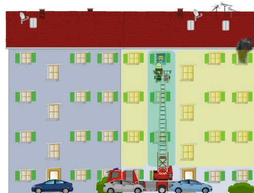
Abbildung 28: Frontalanleitern des priorisierten Anleiterziels mit der Option weitere Anleiterziele in der Frontalen abzudecken.
