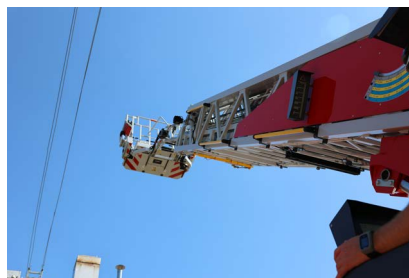
Abbildung 33: Beim links-Eindrehen sind Hindernisse für den Maschinisten früher erkennbar!
