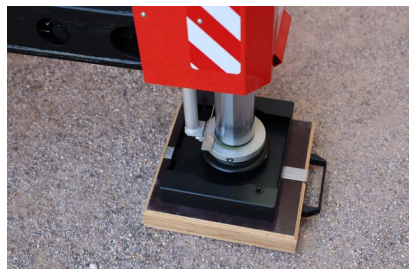
Abbildung 38: Bei losen tragfähigem Untergrund (z. B. verdichteter Schotter) sind die Unterlegplatten zu verwenden
