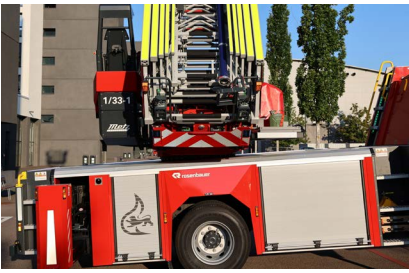
Abbildung 46: Niveaueingleich bei Neigungen
