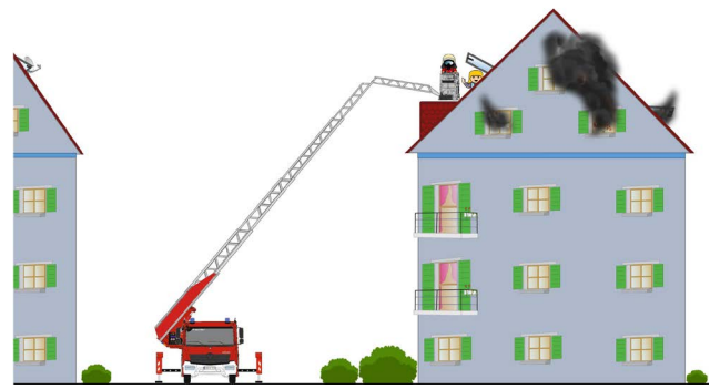
Abbildung 8: Die Menschenrettung aus Dachflächenfenstern gestaltet sich mit der Nutzung des Gelenkes ggf. sicherer.
